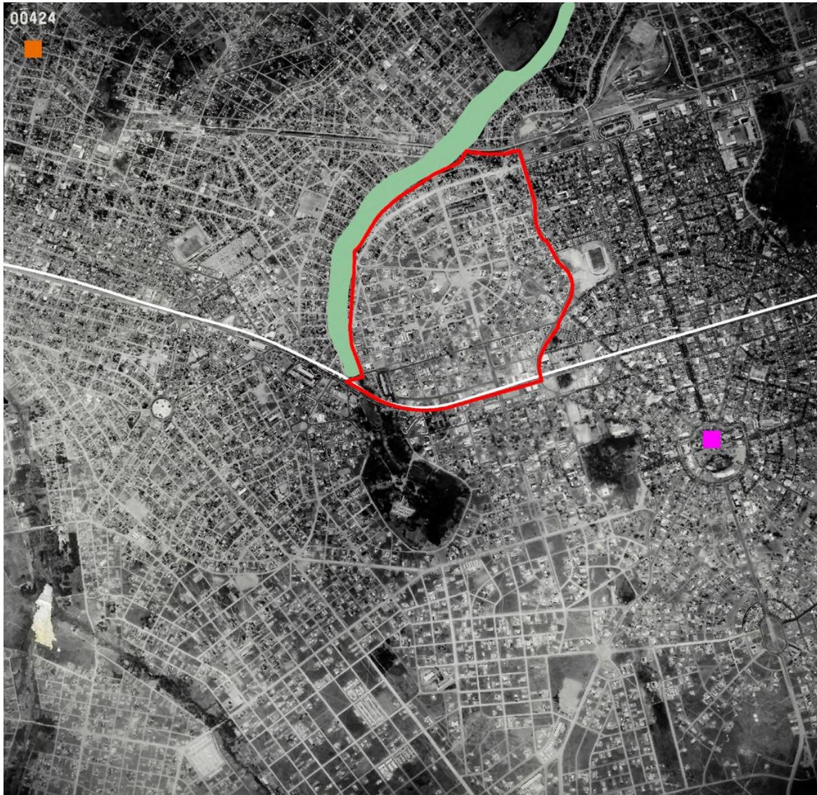
**Figura 1:** Aerofotogrametria destacando a Avenida Anhanguera (em branco), o núcleo de Campinas (em laranja) e do Centro (em magenta), e o limite do Setor Aeroporto (em vermelho). Em verde ocupações irregulares nas bordas do Capim Puba.
