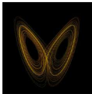
Figura 1 - Diagrama da trajetória do sistema de Lorenz para os valores r=28 , \sigma=10 , b=8/3
